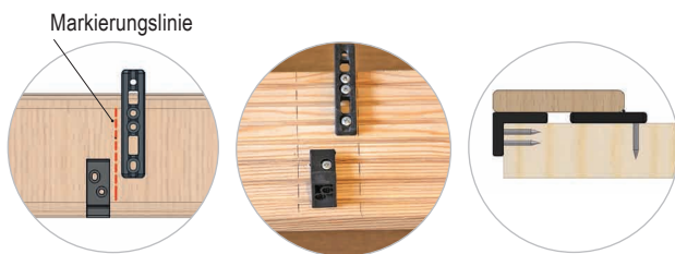
Variante 1 - STIRNSEITIGE Befestigung des Start-Elementes
