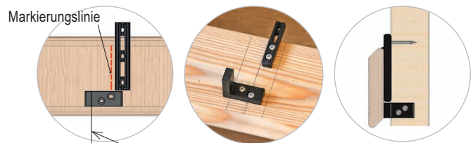
Variante 2 – SEITLICHE Befestigung des Start-Elementes
