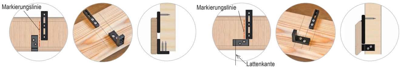
Variante 1 – STIRNSEITIGE Befestigung des Start-Elementes
