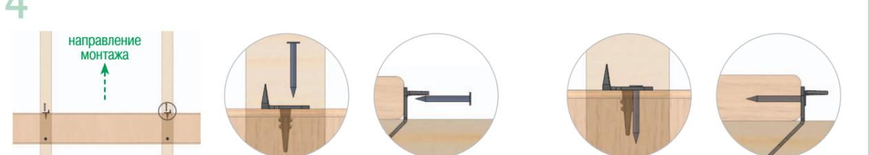
**5** Устанавливаем вторую доску на основание, устанавливаем сборку А-спейсеров, встаем на доски как показано на рисунке, ударами молотка через прокладку набиваем вторую доску на шипы крепежа.
