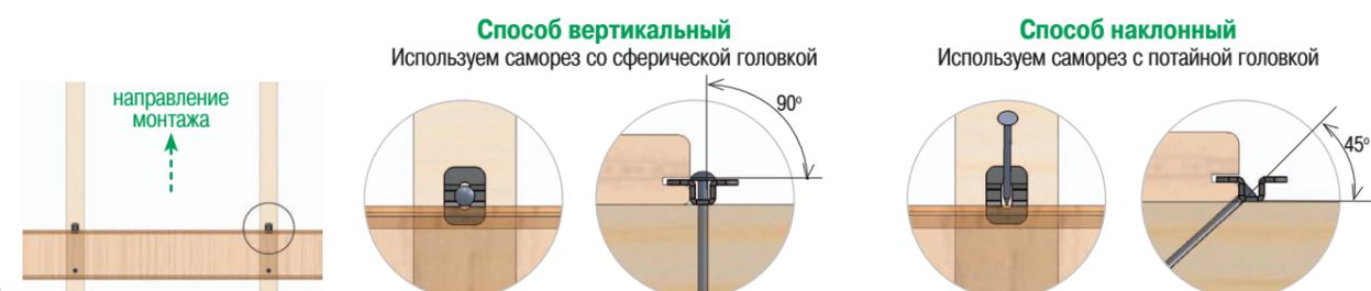
**3** Устанавливаем вторую доску на основание. Ударами молотка через прокладку устанавливаем доску в монтажное положение. Монтажный зазор между досками выставляется автоматически 10 мм.
