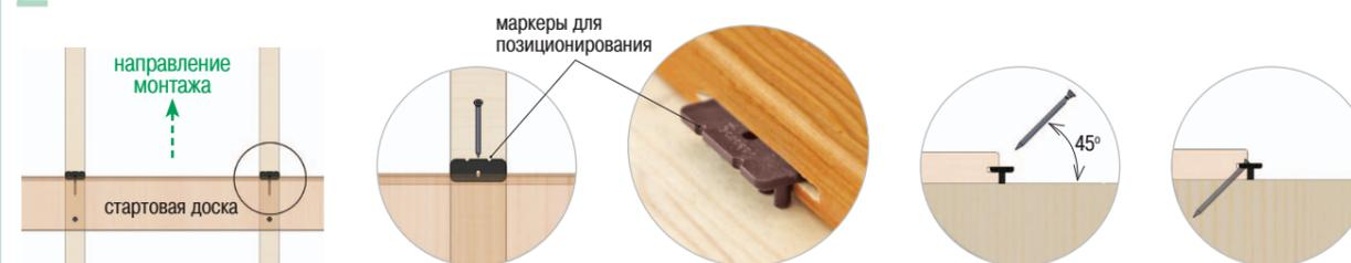
**3** Вторая доска устанавливается пазом вплотную к крепежу TERRA. Крепеж создает начальный монтажный зазор 5 мм.
