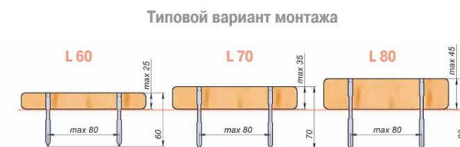
Вариант монтажа с улучшенной вентиляцией и компенсацией разбухания-усадки при применении спейсера C500
