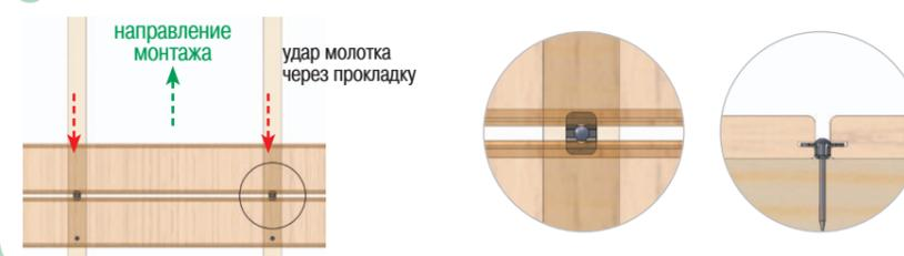
**4** Повторяем действия 2, 3. Свободный край последней доски фиксируем саморезами.
