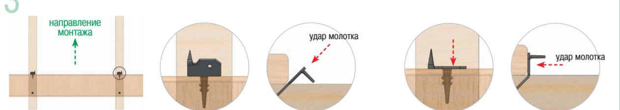
**4** Через отверстие в крепеже фиксируем крепеж на доске саморезом или гвоздем.
