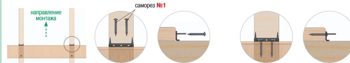
**3** Обеспечиваем плотное прилегание доски к основанию, через монтажное отверстие крепежа закручиваем саморез №2 в основание под углом 45°.
