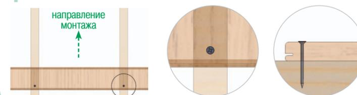
**2** Устанавливаем крепеж на основание, а его любое крыло вставляем в паз доски. Выбираем способ монтажа самореза в основание: вертикальный, наклонный, комбинированный. Для каждого способа монтажа используем саморез требуемой формы. Через монтажное отверстие крепежа шуруповертом закручиваем саморез в основание до момента плотного контакта головки с крепежом, обязательно используем «трещетку».
