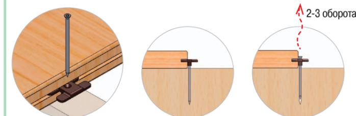
**3** Вторая доска устанавливается пазом вплотную к крепежу ТЕРМО. Крепеж создает начальный монтажный зазор 6 мм. Закручиваем ранее ослабленный саморез.
