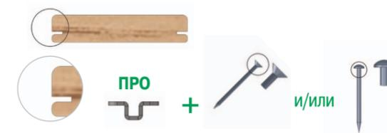
**1** Ориентируем первую доску лицевой стороной вверх, устанавливаем ее на основание и крепим край саморезами требуемого размера. Для обеспечения плотного прилегания доски к основанию желательно использовать саморезы с неполной резьбой.
